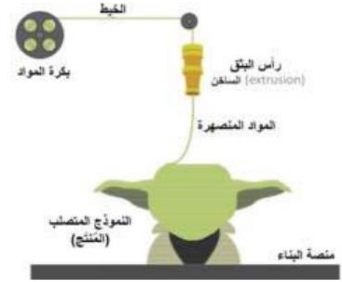
شكل (4) يوضح الطباعة بالترسيب المنصهر (FDM).
